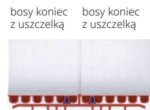
Połączenie rur strukturalnych Pragma*ID poprzez nasuwkę
