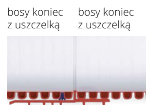
Połączenie rur strukturalnych Pragma poprzez nasuwkę
